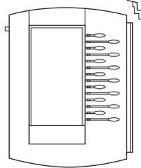
2. Richten Sie das Expansion Modul an den Einkerbungen am SoundPoint IP 670-Telefon aus und schieben Sie es nach unten, bis es hörbar einrastet. Schließen Sie den Gerätehalter für die einzelnen Module an.
