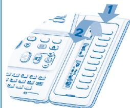
Un boîtier d'extension peut équiper votre poste. Il dispose ainsi de touches supplémentaires configurables en touches de fonction, touches de ligne, touches d'appel ... **Pour mettre en place les étiquettes** : ramener la languette de maintien du cache de touches vers soi et soulever le cache. Installer l'étiquette sous le bloc de touches, dans le logement prévu à cet effet, et mettre à nouveau le cache en place.
